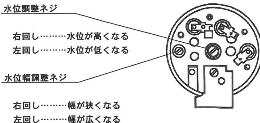
注) 水位幅調整ネジを過大に変更すると カチ、カチとスイッチが連続して作動したり切れたりしますので、その時は水位幅調整ネジを左に回しスイッチ音のカチ、カチがでなくなる程度まで回してください。
